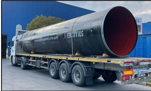
DN 2200, 12m Länge, ca. 15 Tonnen, Epoxybeschichtung
